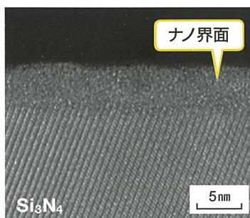
窒化炭素膜と窒化ケイ素ボールの摩擦において、0.01オーダーの低摩擦係数を発現する時にボール摩耗痕に観察されたナノ界面。なじみ過程で形成されるナノ界面がその後の摩擦を支配する。
